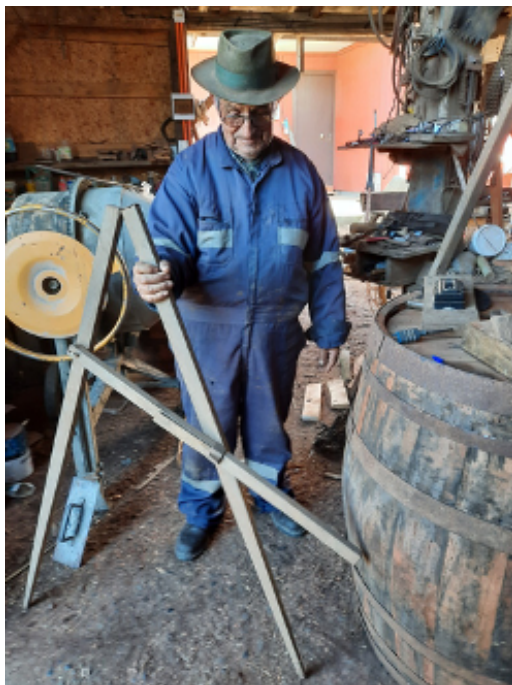
El tonelero mayor del Itata, Daniel Jara Jara, activo artesano e inventor, gran parte de sus 72 años los ha consagrado por completo al arte de dar “cuna y vestido al vino”. La necesidad y su ingenio lo llevó a fabricar sus propias herramientas. Aquí con un gran compás de madera de propia invención y manufactura (Foto Ziley Mora, en Cerro Negro, Quillón).
